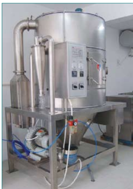
Распылительная сушилка AMDR-5 с производительностью 5 кг/ч по испаренной влаге.
